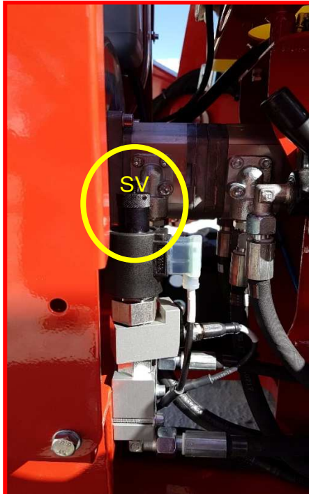
Figure 27 : vanne des stabilisateurs.
