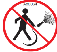
Figure 85 : interdiction de tremper la PEMP.
