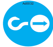
Figure 62 : indication crochets châssis pour transport PEMP.
