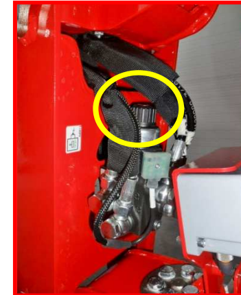
Figure 24 : curseur pour centrage de nacelle.
